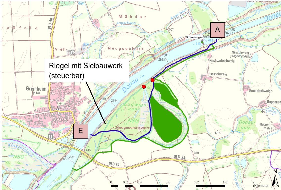
Abbildung 28: Zankwert, Gerinne für ökologische Flutungen (blau), Deichrückbaubereiche (rot), „disable“-Elemente grün
