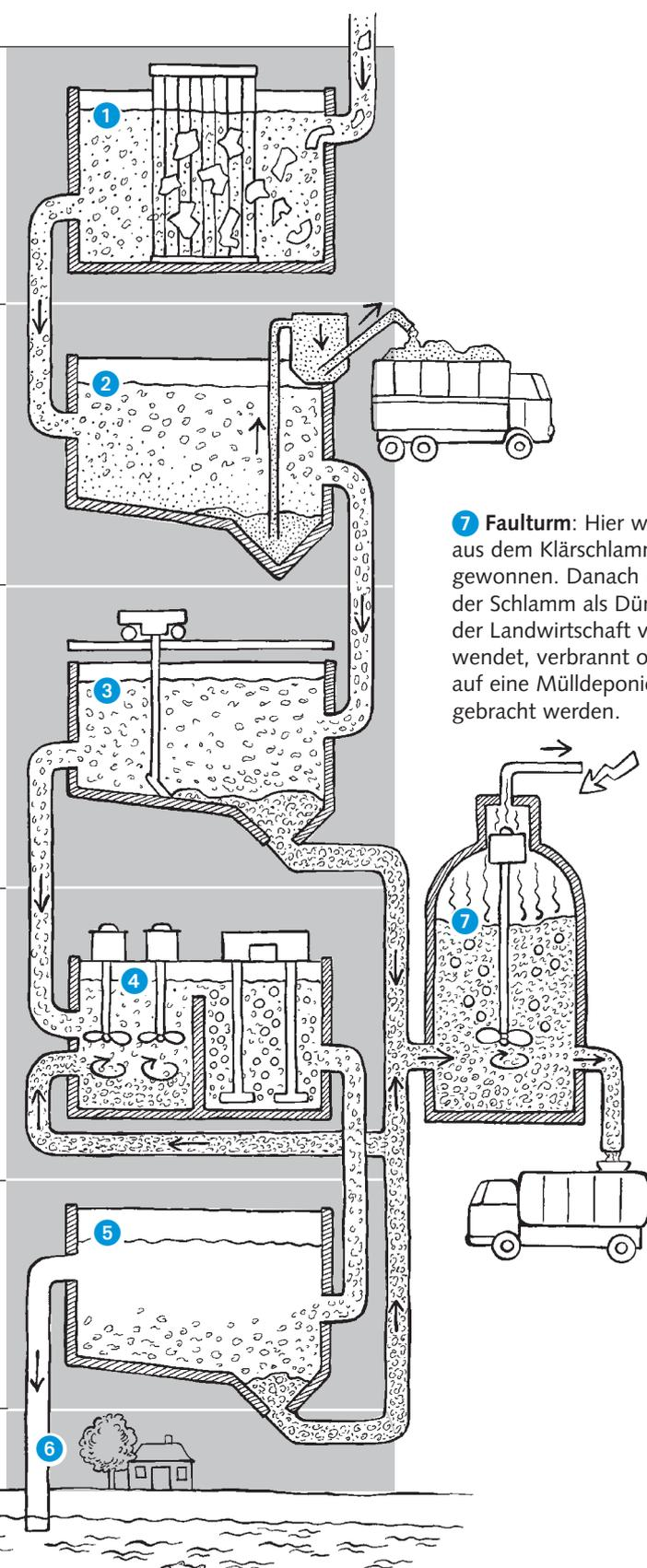
**7 Faulturn:** Hier wird aus dem Klärschlamm Gas gewonnen. Danach kann der Schlamm als Dünger in der Landwirtschaft verwendet, verbrannt oder auf eine Mülldeponie gebracht werden.
