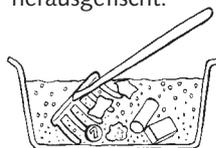
**2 Sandfang:** Sandkörner sinken im langsamer fließenden Wasser nach unten und werden abgesaugt.
