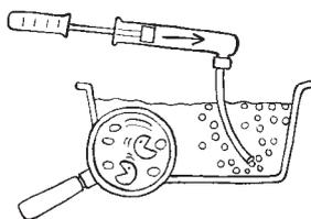
**5 Nachklärbecken:** Schlammflocken mit Bakterien sinken auf den Boden und werden abgesaugt.
